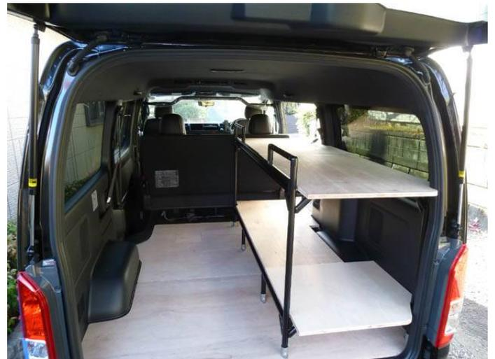
↑ 床面に合板を置き、G-Fun フレームを組んだ上に、ベッド板（18t）を置いてみた。1段目全長2025mm、2段目1935mmの長尺ベッドが作れます。（リアシートが一番前に移動し、リクライニングは1段まで）リアシートのヘッドレストは2段ベッドの枕止めにピッタリです。
