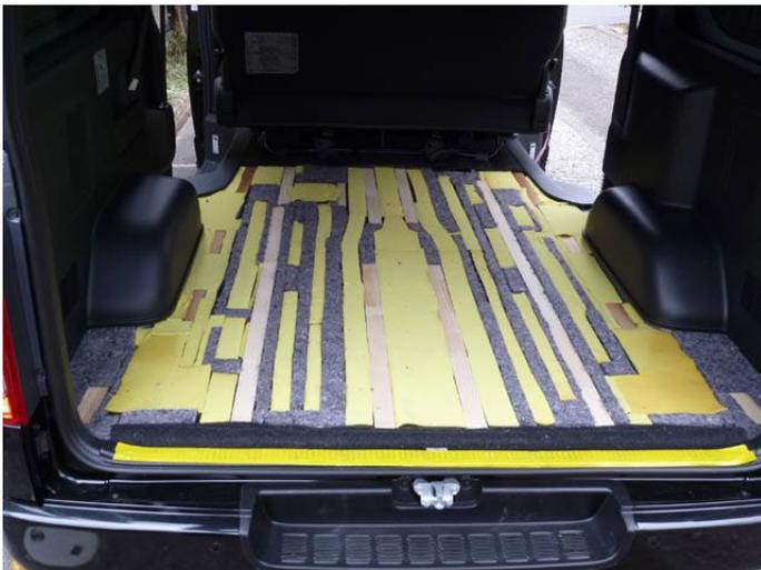
↑ 根太と断熱材を敷き詰めたところ この上に塗装した12mmの構造合板を乗せます。今回は重たいリアシートは残したままの作業とした。標準シートの最後部は少し残してあり（黄色テープの所）合板で押さえ込みます。まさかのタイヤハウスの高さ違いも見えます。
